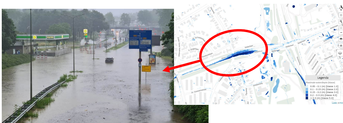
Figuur 6.5 Wateroverlast op de A79 ter hoogte van Heerlen op 14 juli 2021 (links, foto Orange media) en de T10 kaart voor kortdurende hevige regenval uit Landelijk Informatiesysteem Water en Overstromingen (LIWO, 2022)
