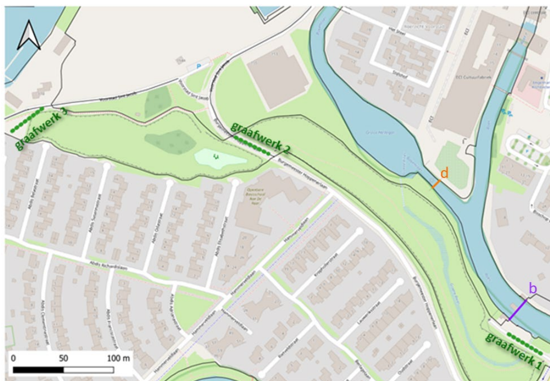
Figuur 7.13 Detailweergave van de Roer-overlaat en locaties waar graafwerk uitgevoerd moet worden (groene stippellijnen) bij inzet van de Roer-overlaat. Verder illustreert b de zuidelijke keersluis en d de stuw Groot Hellegat
