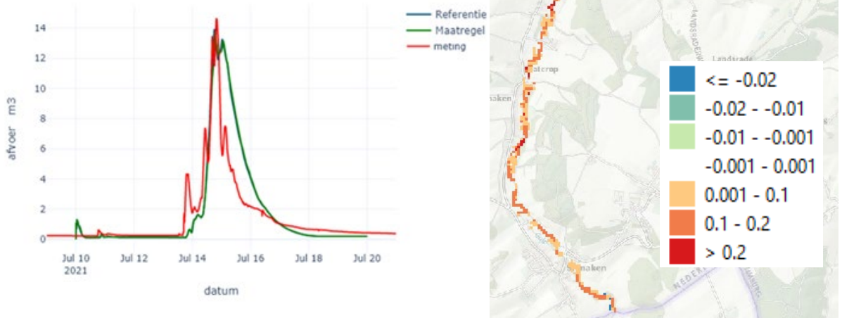
Figuur 5.10 Links: verloop afvoeren meetpunt Azijnfabriek (Gulp), met in blauw het referentiemodel en in groen met de maatregel voor juli 2021 berekening en rechts het verschil in maximale waterhoogte tussen referentie en maatregel (in meter).
